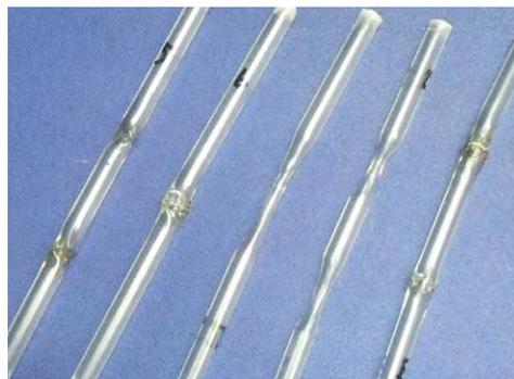
図1 精度検証に用いた自作の狭窄血管ファントム
