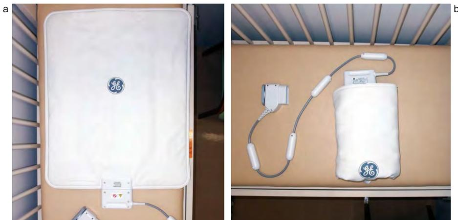
図1 軀幹部用 AIR コイル (AIR Anterior Array コイル)
