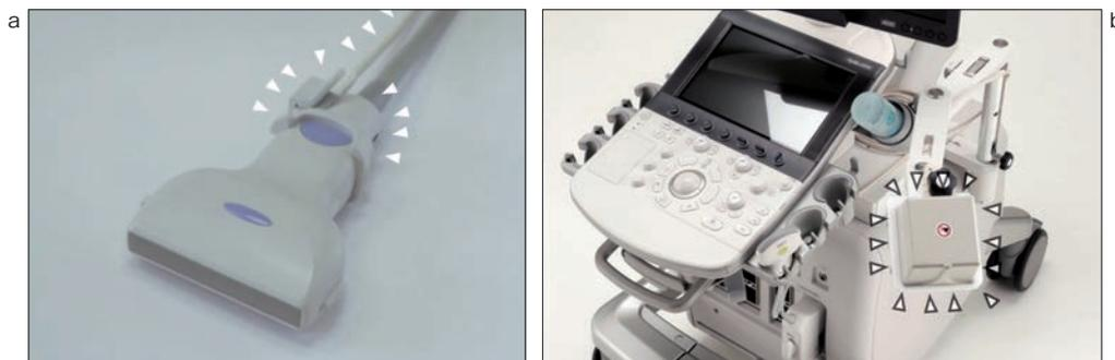
図1 フュージョンイメージングを行う際に必要な位置センサと磁場送信機
