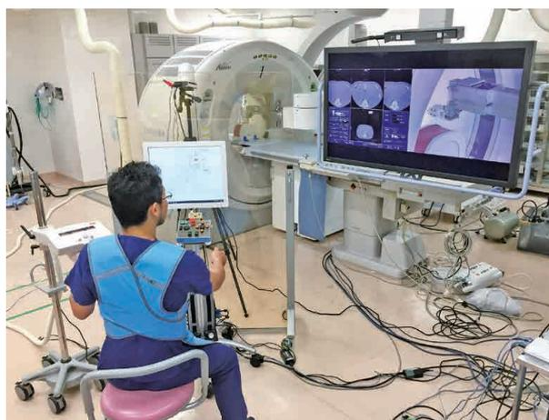
図2 CT透視ガイド下針穿刺ロボット（Zerobot）および非臨床試験の様子
