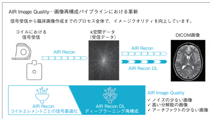
図1 AIR Image Qualityの画像再構成パイプライン (画像提供: GEヘルスケア・ジャパン株式会社)
